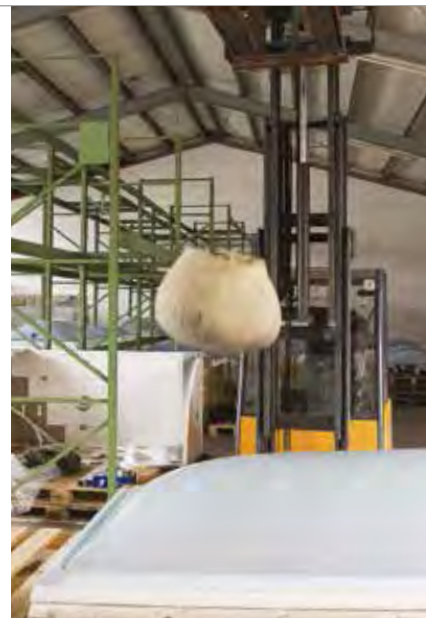
■ Der genormte 50 kg Sack wurde aus einer Höhe von 1,20 m auf eine Kemperol Fallstop beschichtete Lichtkuppel fallen gelassen.
