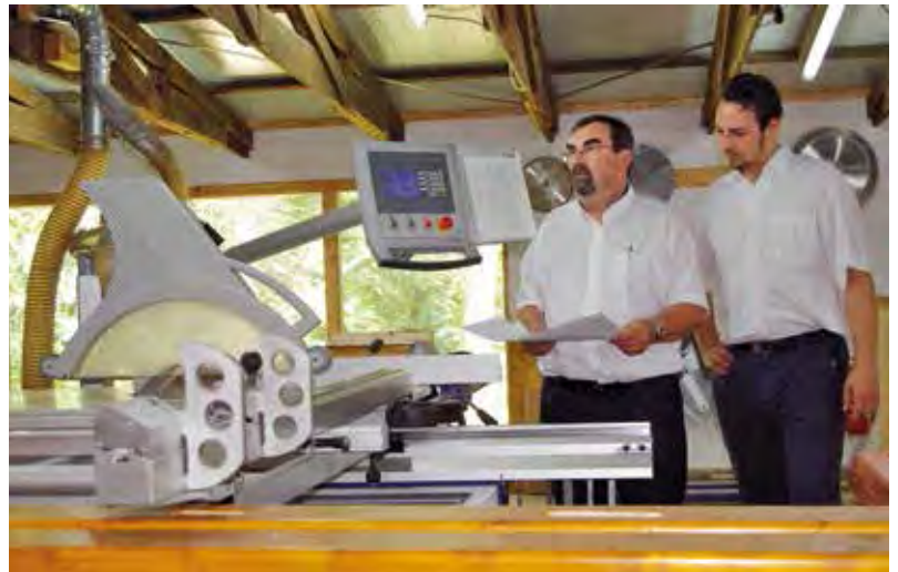
■ Mit der computergesteuerten Formatkreissäge erledigen Uwe Pikart und Jörg Pikart (re.) seit 2010 Platten-Zuschnitt und Abbind.
