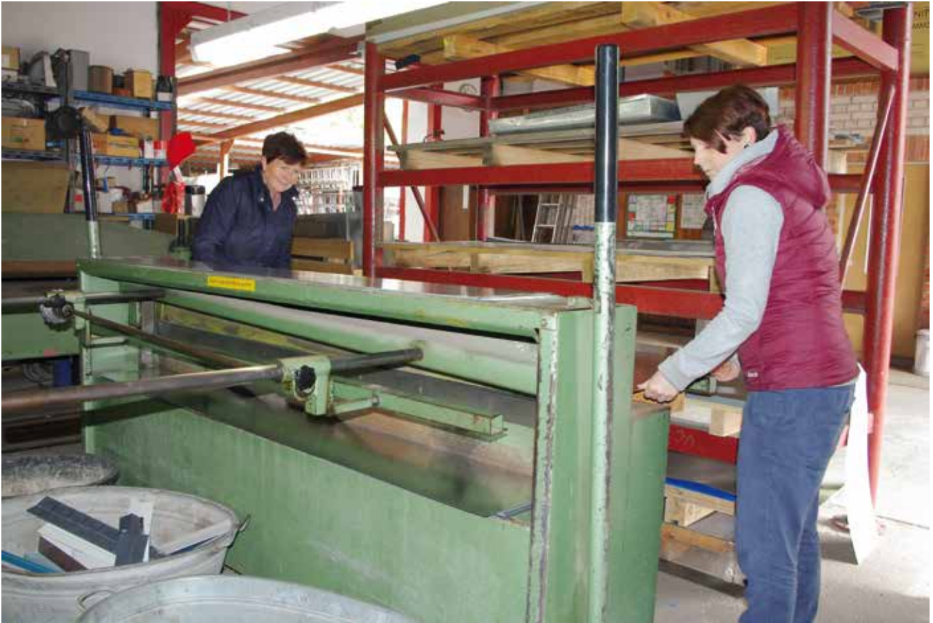
Inhaberin Susann Mai (links) und Dachdeckermeisterin Juliane Mai bearbeiten an der Kantbank Metallprofile.
