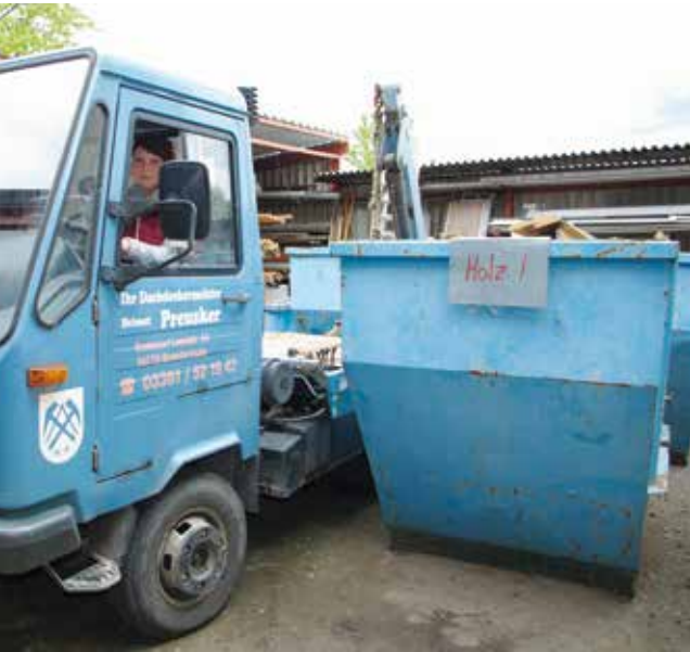
Die Dachdeckerei sammelt und sortiert Bauabfälle in eigenen Containern. Mit dem legendären „Multicar“ lassen sich die Behälter auf- und abladen sowie transportieren.
