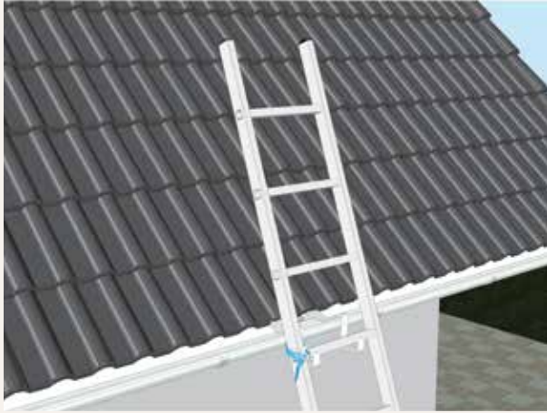
Beispiel Leitersicherung für das Steildach: Zur Befestigung am Sparren oder der Traufbohle - dient als Fixierung einer Anlegeleiter gegen seitliches und rückwärtiges Wegkippen
