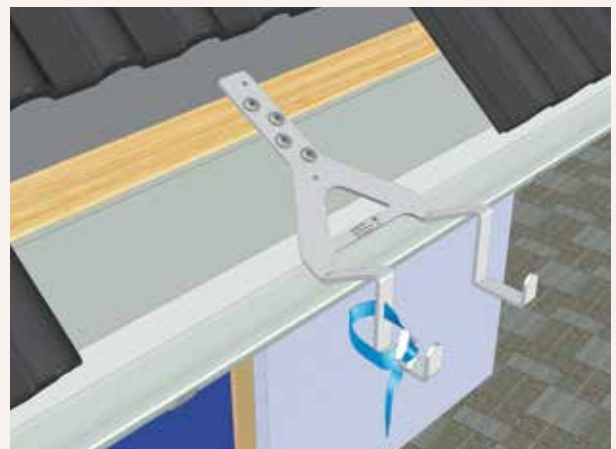
Beispiel Leitersicherung für die Montage auf einer Konterlattung oder einer Traufbohle
