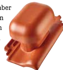
Der ERLUS ALU-Sanitärlüfter mit abnehmbarem Deckeleinsatz, Anschlusschlauch 70 cm, DU-Manschette und Reduzierstück, pulverbeschichtet
