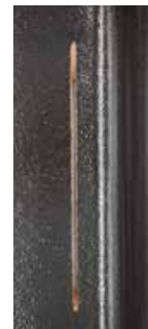
AkkuMAX -Schnittbreite bei Ø 230 mm: ca. 1,76 mm
