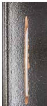
Standard-Schnittbreite bei Ø 230 mm: ca. 3,2 mm
