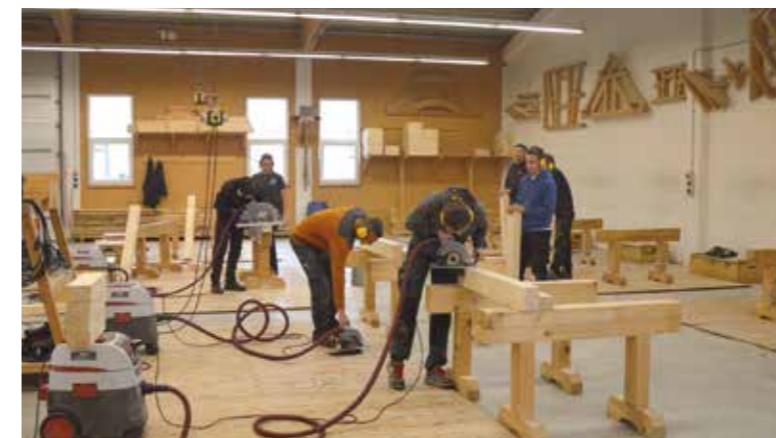
Zuschneiden der Holzelemente: Dachstuhlbau in Theorie und Praxis gehört zum Ausbildungsplan.
