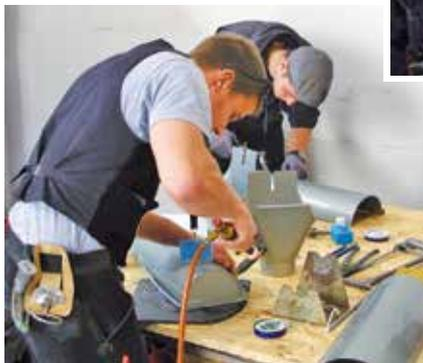
gabe hier: Einlöten zweier Böden in ein Rinnenstück, Öffnung für den Stutzen ausschneiden und Einhangstutzen einfügen. Bewertet wurden Zeit und Qualität der Lötnaht. Eine zweite Gruppe montierte das Rheinzink Drehhaltersystem an eine vorbereitete, provisorische OSB Wand. Hier waren die Gesellen durch ihre Tätigkeit auf der Baustelle auf vertrautem Terrain.
