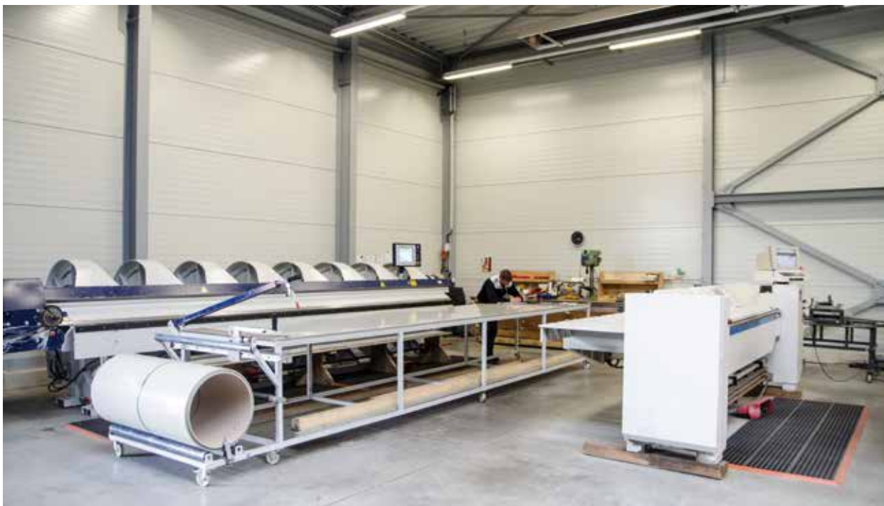
■ Eine große Bauklempnerei gehört zum Betrieb Jansen, in der alle Abkantungen für die umfangreichen Industriedächer ausgeführt werden.
