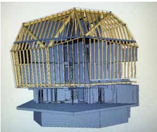
■ Es galt, auf einem Unterbau aus Beton eine Holzkonstruktion zu erstellen, die das komplette Gebäude umschließt.
