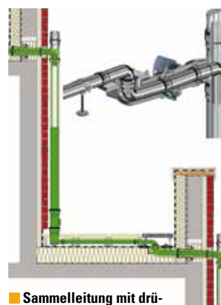
Sammelleitung unter dem Terrassenbelag.
