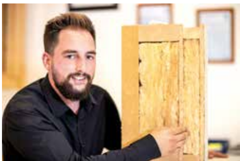
Moritz Loës leitet den Bereich Holzbau. Hier zeigt er ein Stück gedämmtes Brettsperrholz, mit dem er tragende Wände baut.
