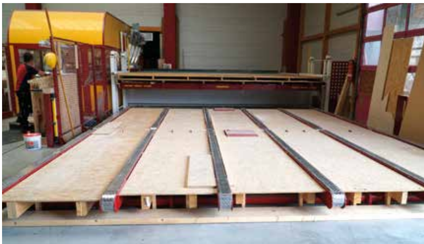
Die Speed-Panel-Machine (SPM) sorgt für den exakten Plattenzuschnitt.
