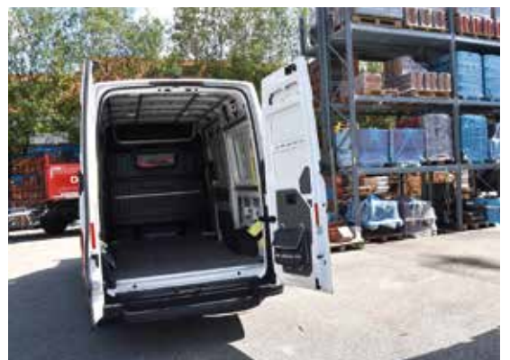
Mit dem Akku-Paket unter dem Ladeboden geht kein Liter Laderaum verloren.
